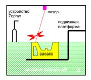
4. Лазер формирует следующий слой детали. Процесс повторяется автоматически, без участия оператора, до полного изготовления детали.
