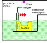
3. Устройство Zephyr проходит над поверхностью детали, покрывая ее тонким слоем жидкого полимера.
