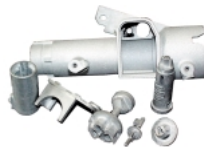
Замок зажигания (по выжигаемой модели)
