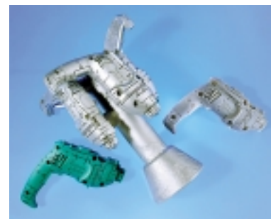
Пуансон пресс-формы (по выплавляемой модели)
