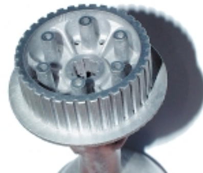
Ролик (по выплавляемой модели ThermoJet)
