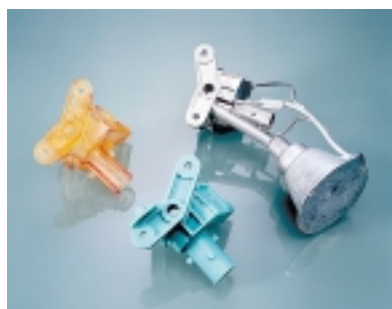
Корпус (по выплавляемой модели)
