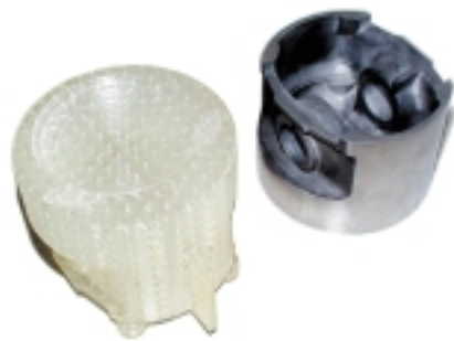
Поршень (по выжигаемой модели)
