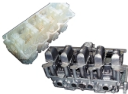
Головка блока цилиндров (по выжигаемой модели)
