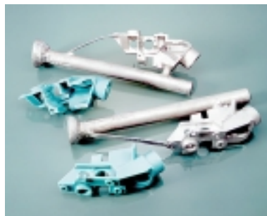
Кронштейн (по выплавляемой модели)
