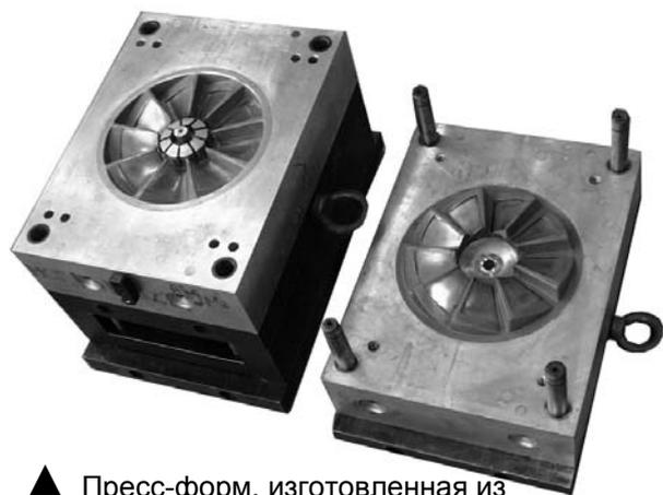
▲ Пресс-форм, изготовленная из металлополимерной композиции EP 310 для детали из стеклонаполненного полиамида
