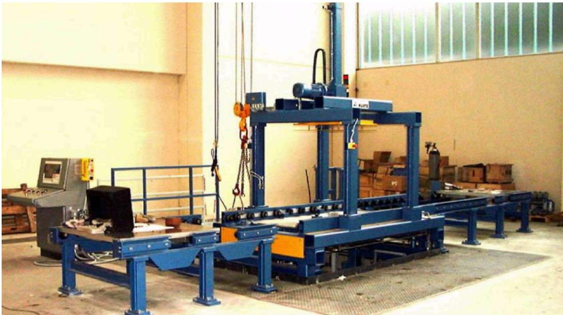
В наиболее простых установках перемещение форм или песчаных пакетов производится преимущественно вручную. Тем не менее уже при мелких сериях желательна транспортная система, которая может также дальше расширяться с возрастающей мощностью производства. Ничто не мешает дальнейшей автоматизации процесса.
