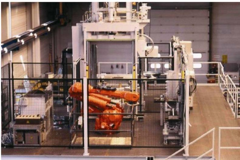
В этом проекте KURTZ участвовал как разработчик кокилей и оборудования для литья. Силами литейного производства KURTZ тестировались и дорабатывались кокили и обеспечивалось снабжение финального потребителя отливками до принятия литейной установки в эксплуатацию заказчиком.
