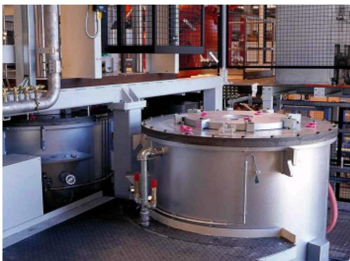
Технология литья под низким давлением имеет преимущества по отношению к другим способам, так как металл перед литьем находится в закрытом объеме печи. Имеется достаточно времени чтобы расплав отстоялся и приобрел оптимальную температуру. При использовании концепции сменных печей возможна даже закрытая дегазация после наполнения печи. Избегается происходившее до сих пор ухудшение качества металла вследствие переливания из транспортного ковша. При выборе концепции печи решающим
