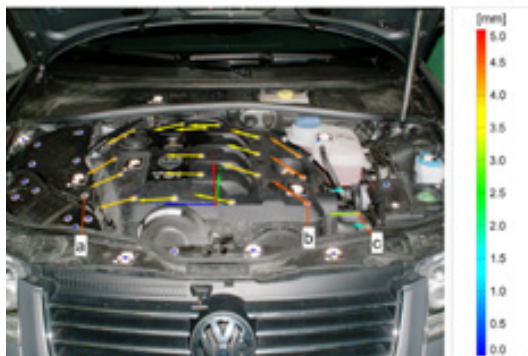
Динамический анализ смещения двигателя при запуске
