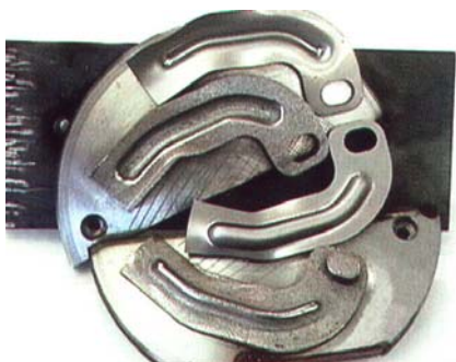
Небольшой стальной штамп и штампованная деталь толщиной 3 мм. Изготовлены за один день.
