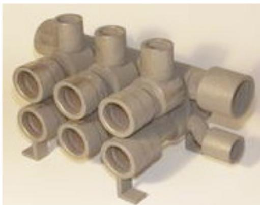
Корпус для гидросистемы из титана. Быстрое изготовление опытных образцов
