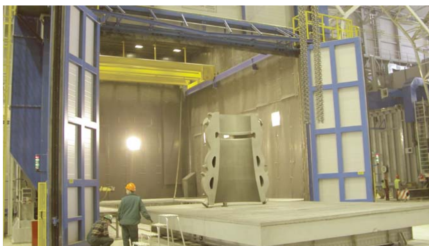
Камерная пневматическая установка очистки с манипулятором, управляемым системой PLC
